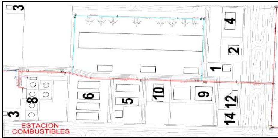
Figura II.69 Trayectoria de los ductos de 24" de suministro de turbosina a red de abastecimiento.
